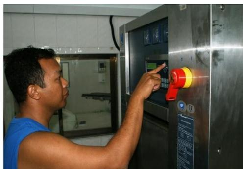
Retour de Bruno, remontage du condenseur puis, essai d'un cycle B&D et « INSTRUMENT ». tout fonctionne parfaitement.
