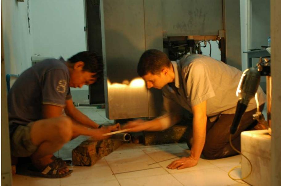
La pompe à vide étant bloquée, nous la démontons, la remettons en service et en place.
