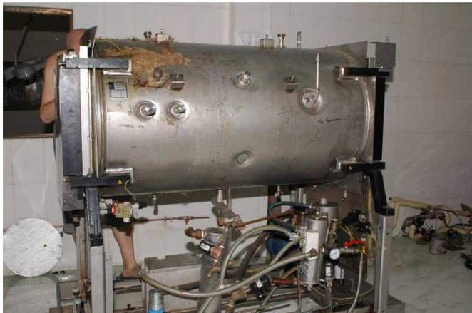
Afin d'effectuer une mise à l'épreuve des soudures de la chambre, nous devons d'abord contrôler que l'étanchéité des portes (via les joints) est bonne.
