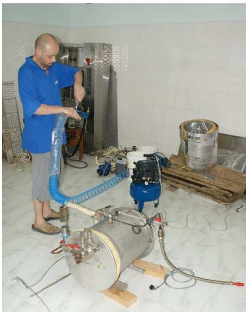
Remplissage en eau du surchauffeur et mise sous pression d'air sous 4 bars. **Le résultat est positif.** Calorifugeage du surchauffeur et remise en place. Remontage provisoire de la tuyauterie (étanchéité non assurée) en suivant les repères faits par David et Piezo. Nous continuons par l'armoire électrique. Nous terminons notre travail par des photos des différents organes et le listing des pièces à changer (uniquement après contrôles visuels)
