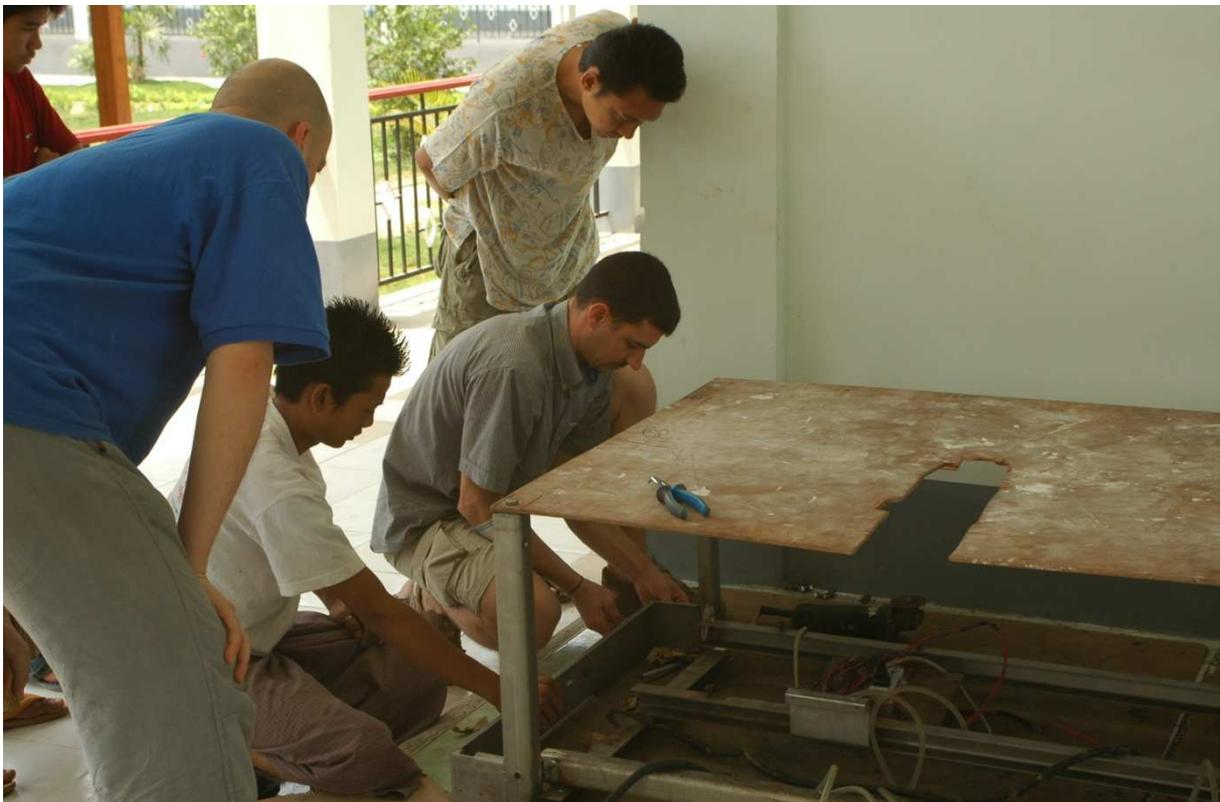
Une fois le travail validé nous procédons à l'opération inverse. Remise en place sur le châssis de la pompe à vide, du condenseur et de la bache. Comme pour la dépose de la chambre, nous faisons
