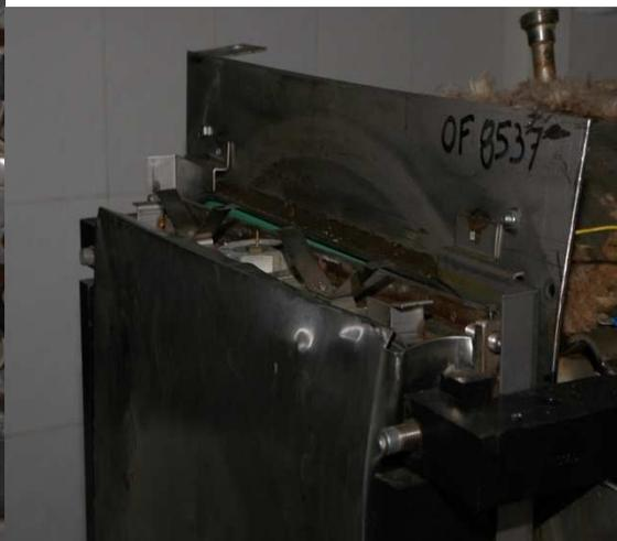
L'équipe précédente a fait ressouder le châssis afin que l'ensemble se maintienne jusqu'à notre arrivée. David, lors de sa précédente mission a commencé avec l'aide de Piezo à « déshabiller » et à repérer les différentes parties de l'autoclave.
